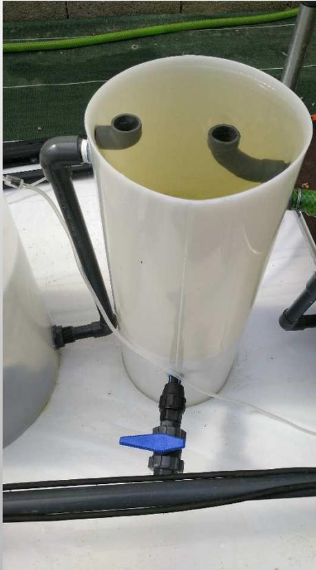
El agua procedente del tanque de peces llega a este depósito, donde las partículas mas grandes por efecto de la gravedad se depositan en el fondo.
